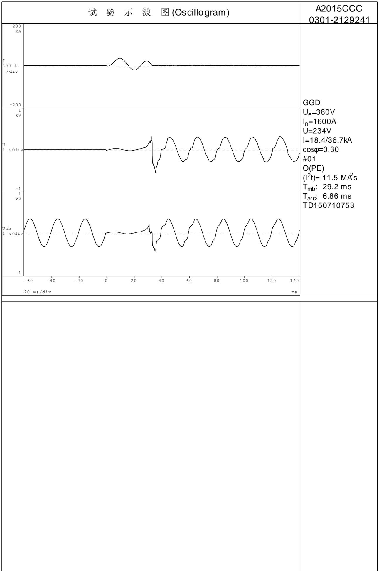
$I_p$ : 电流峰值 (Peak current)    $I^2t$ : 焦耳积分 (Joule integral)    $T_{mb}$ : 通断时间 (make-break time)    $T_{arc}$ : 燃弧时间 (arcing time)
